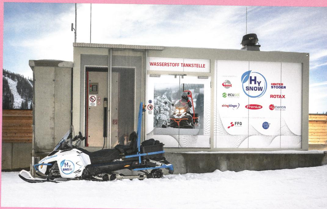
**Skidoo mit Tankstelle.** Im Skigebiet Wurzeralp bei Hinterstoder wird mit Sonnenstrom Wasserstoff gewonnen, gelagert und an das Brennstoffzellen-Schneefahrzeug abgegeben.
